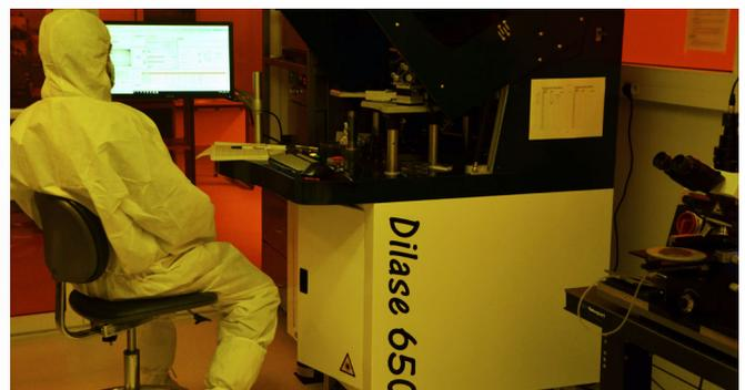
Figure 9 : Équipement de lithographie laser UV 375 nm multifonction
