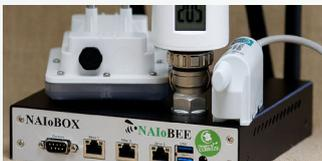
**Figure 2 :** NAIoBox Starter, capteur de télérelève du gaz, thermostat connecté et capteur de température et taux d'humidité du sol.
