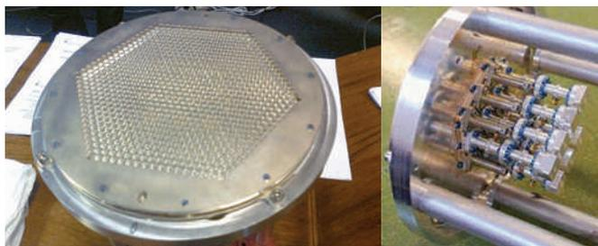
**Fig.3 – Antenne multifaisceaux à diversité de polarisation et de fréquence remplaçant 2 antennes embarquées classiquement sur un satellite**
