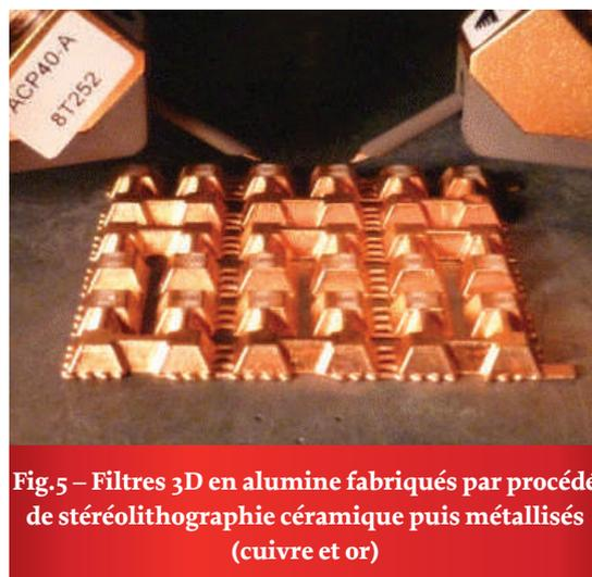
**Fig.5 – Filtres 3D en alumine fabriqués par procédé de stéréolithographie céramique puis métallisés (cuivre et or)**
