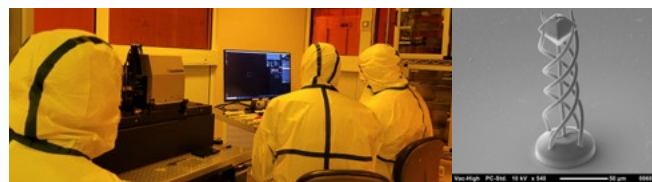
Figure 15 : Système polyvalent de microfabrication additive de structures métalliques installé en salle blanche et exemple d'objet réalisé avec cet équipement
