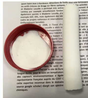
Les différentes étapes de synthèse, de la poudre de verre optique à la préforme optique.
